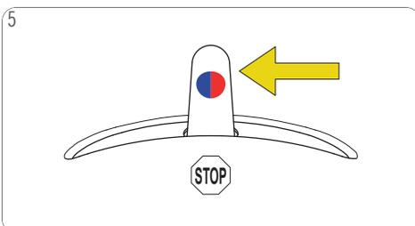
Manténgase al lado de la máquina a lo largo de la preparación. Después de alcanzar el nivel deseado, mueva la palanca de selección a la posición "ALTO". La máquina detiene la preparación.
